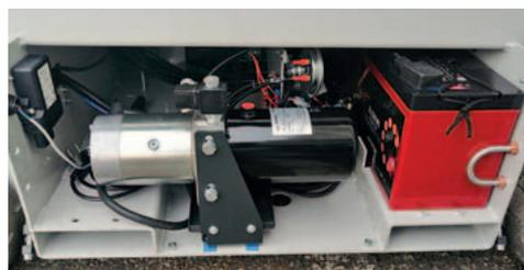
Batterie AGM con facile accesso per la manutenzione. Nuova disposizione dei componenti idraulici sul carro base, dotato di guide per carrello elevatore.
